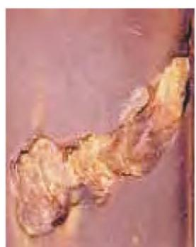
Коррозийная трещина на стенке нагревательного котла
